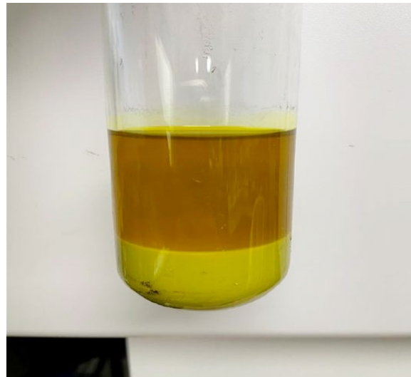
Figure 2 – After digestion using Aqua Regia digestion
